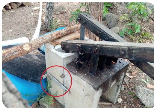
(Lubricar también el cincho sujetador especialmente los tornillos)
