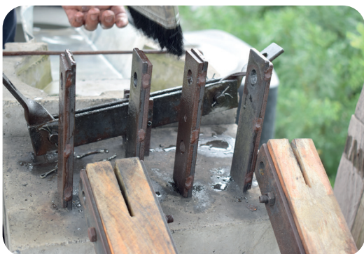
(Lubricar hierro sujetador)
